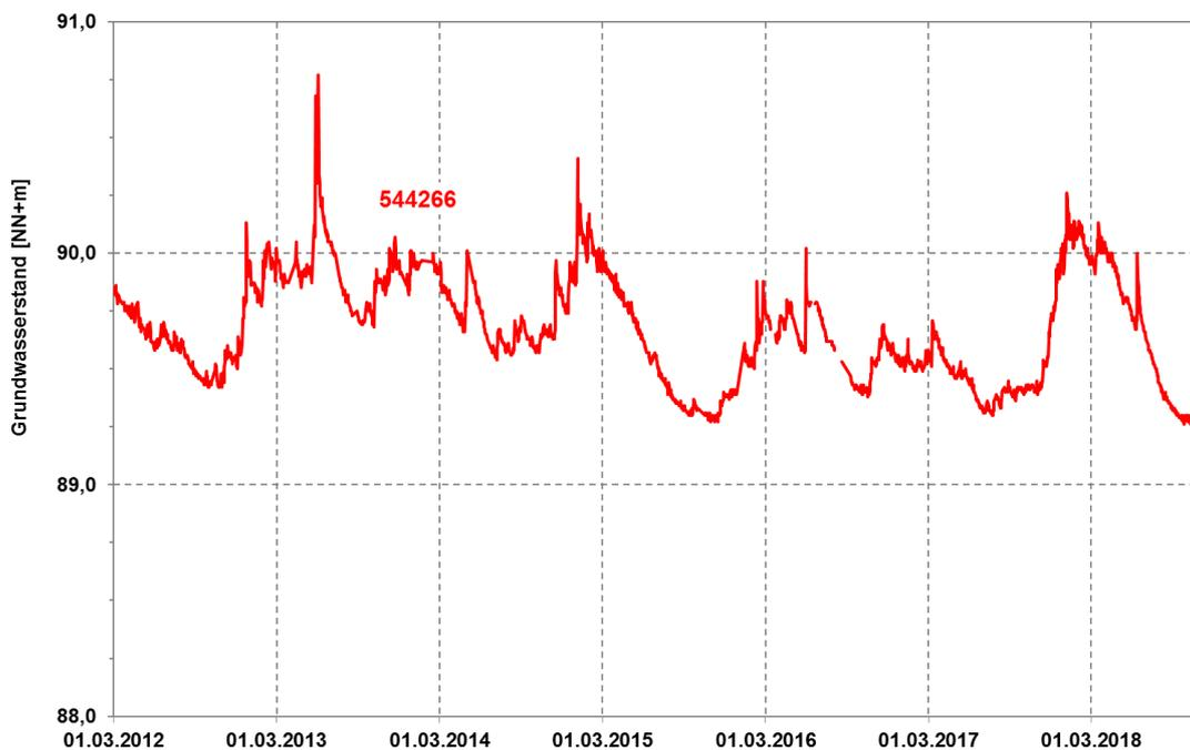
Abb. 11: Grundwasserganglinie der Messstelle 544266 im Hessischen Ried; trotz der geringen Entfernung von ca. 50 m zum nächsten Beregnungsbrunnen eines Bewässerungsverbandes mit etwa 45 Brunnen überwiegen in dem mächtigen Porengrundwasserleiter die witterungsbedingten bzw. jahreszeitlichen Schwankungen des Grundwasserstandes (Quelle: Hess. Landesamt für Naturschutz, Umwelt und Geologie)
